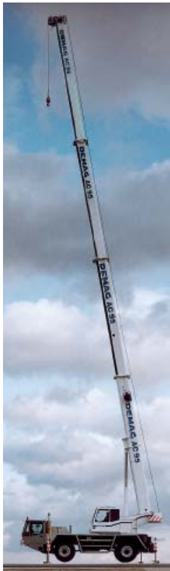
Bild 1: Ohne Stähle wie DILLIMAX wären Kranausleger dieser Länge undenkbar. (Bild mit freundlicher Genehmigung der Demag Mobile Cranes GmbH, Zweibrücken)
